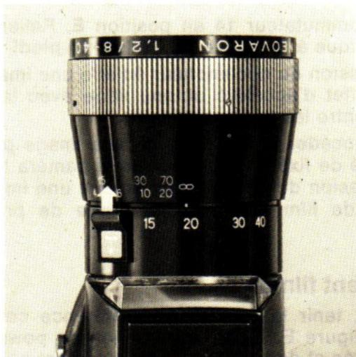
4. Pousser la touche de réglage de la focale vers l'avant, en direction de la flèche (voir figure) et mettre au point en tournant vers la droite — le sujet et le centre de réticule doivent tous deux se présenter avec netteté.
