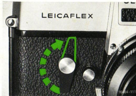
Das Vorlaufwerk ist bei allen Verschußzeiten wirksam. Es wird durch eine 180°-Drehung des Hebels (5) aufgezogen und über den Auslöseknopf (3) in Gang gesetzt. Dazu ist vorher der LEICAFLEX-Verschuß mit dem Schnellschalthebel (4) zu spannen. Die Vorlaufzeit bis zur Belichtung beträgt etwa 10 sec. Während dieser Zeit läuft der Hebel (5) in seine Endstellung zurück. Kurz bevor er sie erreicht hat, wird der Verschuß ausgelöst.
